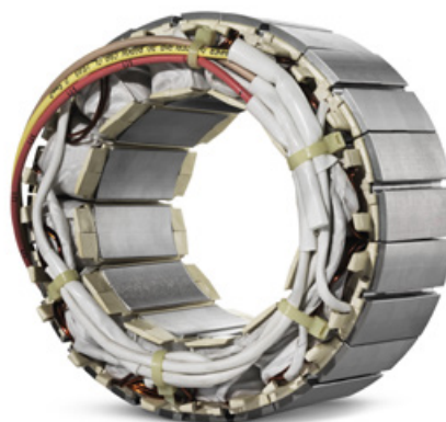
Motor kategorije IE4 sistema Concertor je krajši in kompaktnější od konvencionalnega motorja zaradi svoje zasnove statorja s koncentriranim navitjem.
